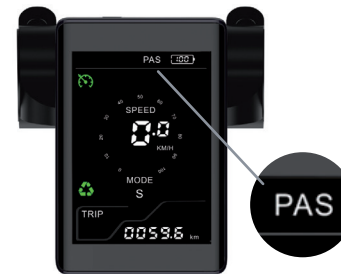
La trottinette est en mode démarrage assisté, ce qui signifie que vous avez besoin de prendre un peu de vitesse au départ pour activer l'accélérateur
